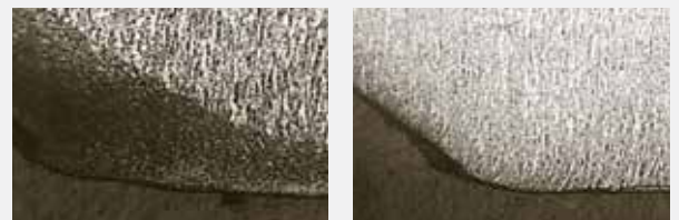
Nitrode após 1200 pontos de solda
