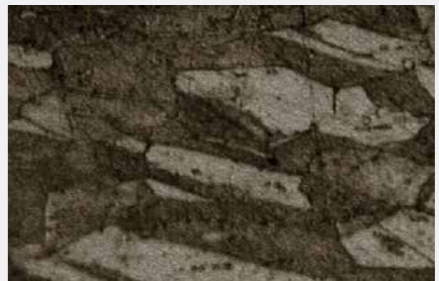
Estructura convencional de grano CuCrZr
