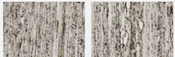
Nitrode до и после размягчения при 900°
