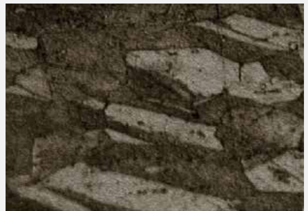
Estrutura convencional de grãos CuCrZr
