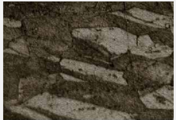
Structure de grain du CuCrZr conventionnelle
