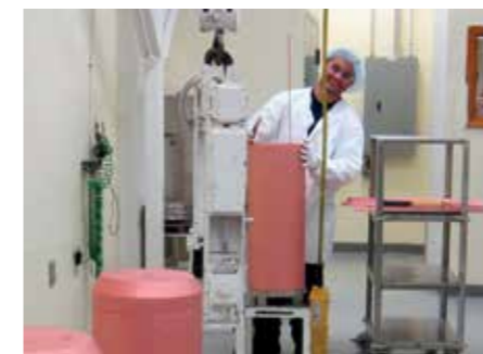
多芯坯料组装
