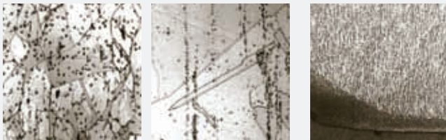
CuCrZr antes y después del recocido a 900°
