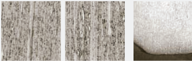
Nitrode-Elektrode vor und nach dem Glühen bei 900 °C
