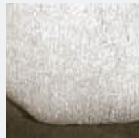
Nitrode nach 1200 Schweißnähten
